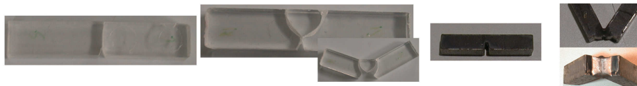
FIGURE 17: Echantillons rompus par choc IZOD (polystyrène à gauche) et CHARPY (acier doux à droite).
